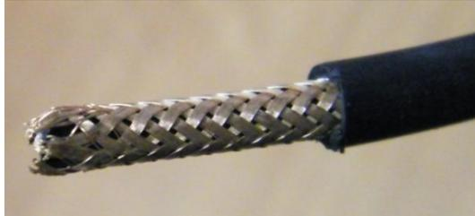
Чтобы сформировать общий вывод, расплетается часть экрана и скручивается для последующей пайки.
