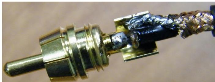
Монтаж завершается установкой пластикового цангового зажима на проводник и прикручиванием корпуса на разъем.
